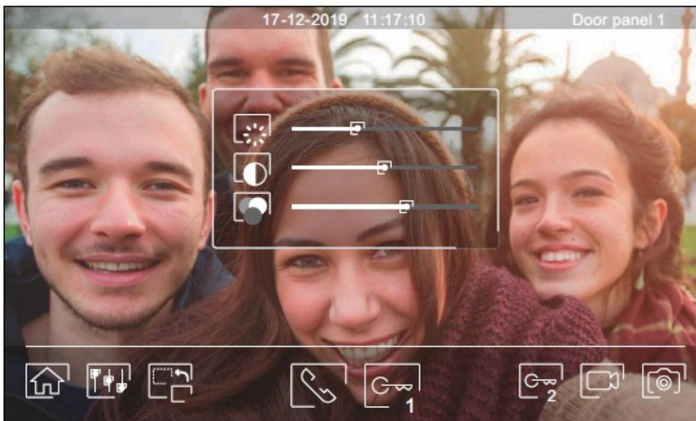
Během procesu komunikace je možno nastavit parametry obrazu (jas, kontrast, barva) a hlasitost reproduktoru monitoru.
