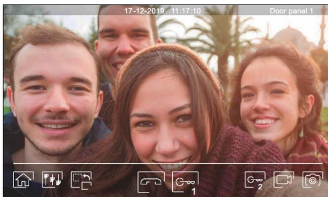
Tato obrazovka je zobrazena během procesu komunikace. Uprostřed nahoře je zobrazeno datum, čas. V pravém horním rohu je zobrazen zdroj komunikace (vstupní panel 1, vstupní panel 2, kamera1 nebo kamera 2).
